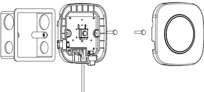
1. 将设备安装在86盒上，用两颗螺丝固定
