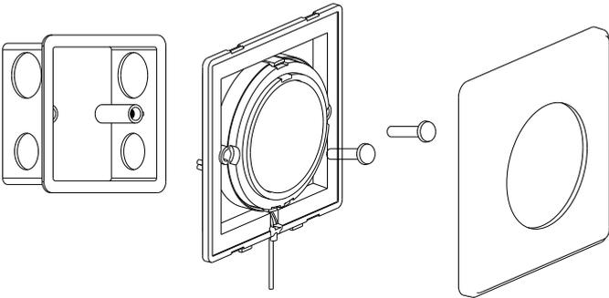
1. 将设备安装在86盒上，用两颗螺丝固定
